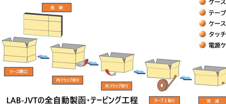
LAB-JVTの全自動製函・テーピング工程
